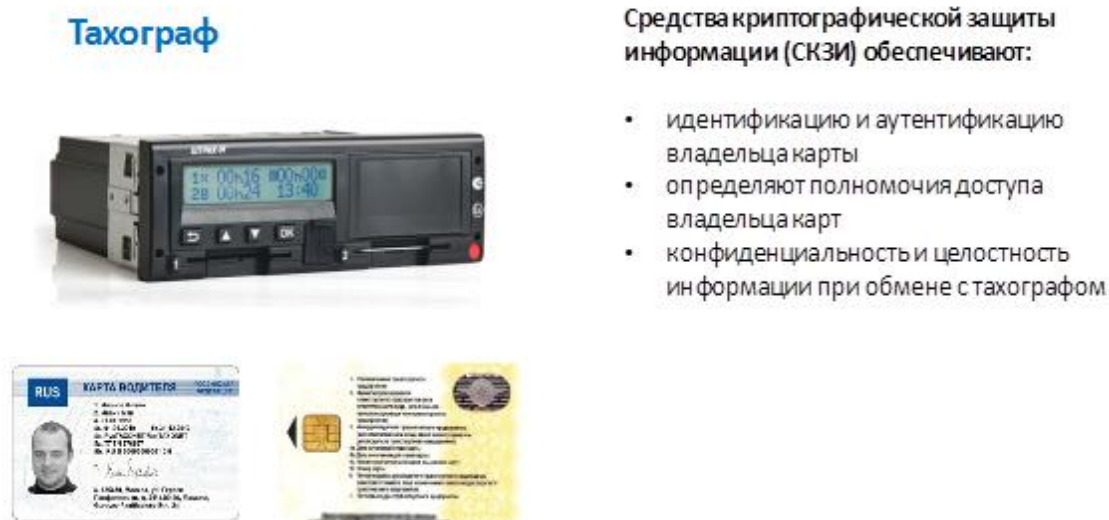
Рис. 3. Внешний вид тахографа и электронной карты водителя
